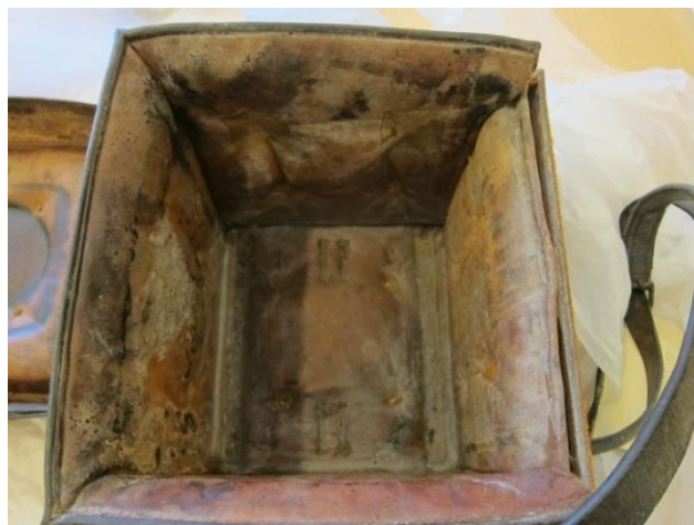
Det indre af lædertasken med kraftig foring til beskyttelse af instrumentkassen.
