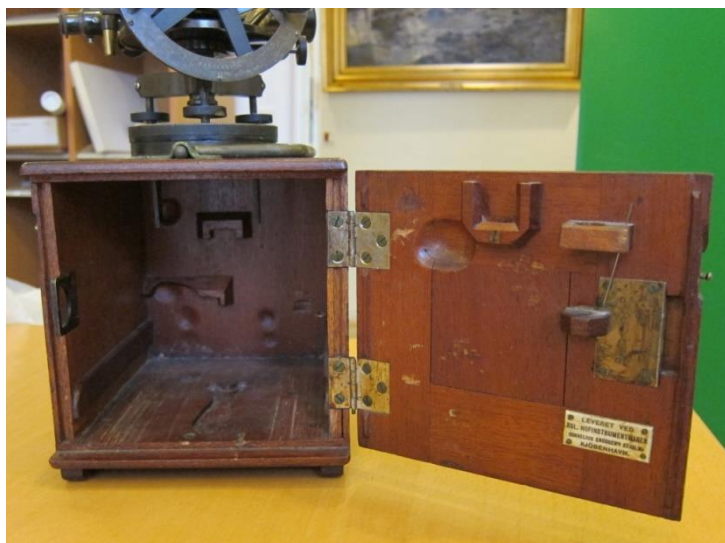
Instrumentkassen med sidelågen åben, så man kan se det rum, teodolitten opbevares i.
