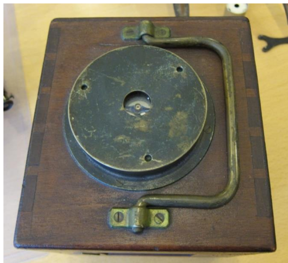
Toppen af instrumentkassen med hank og huller til at anbringe teodolittens tre ben i.
