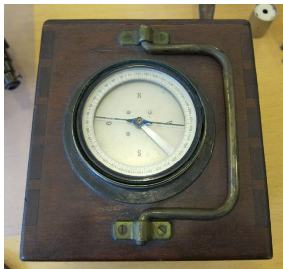
Metallåget med de tre små huller kan skrues af. Nedenunder er et kompas. Det store hul i midten af metallåget kan bruges til at holde øje med kompasretningen, når man bruger teodolitten.
