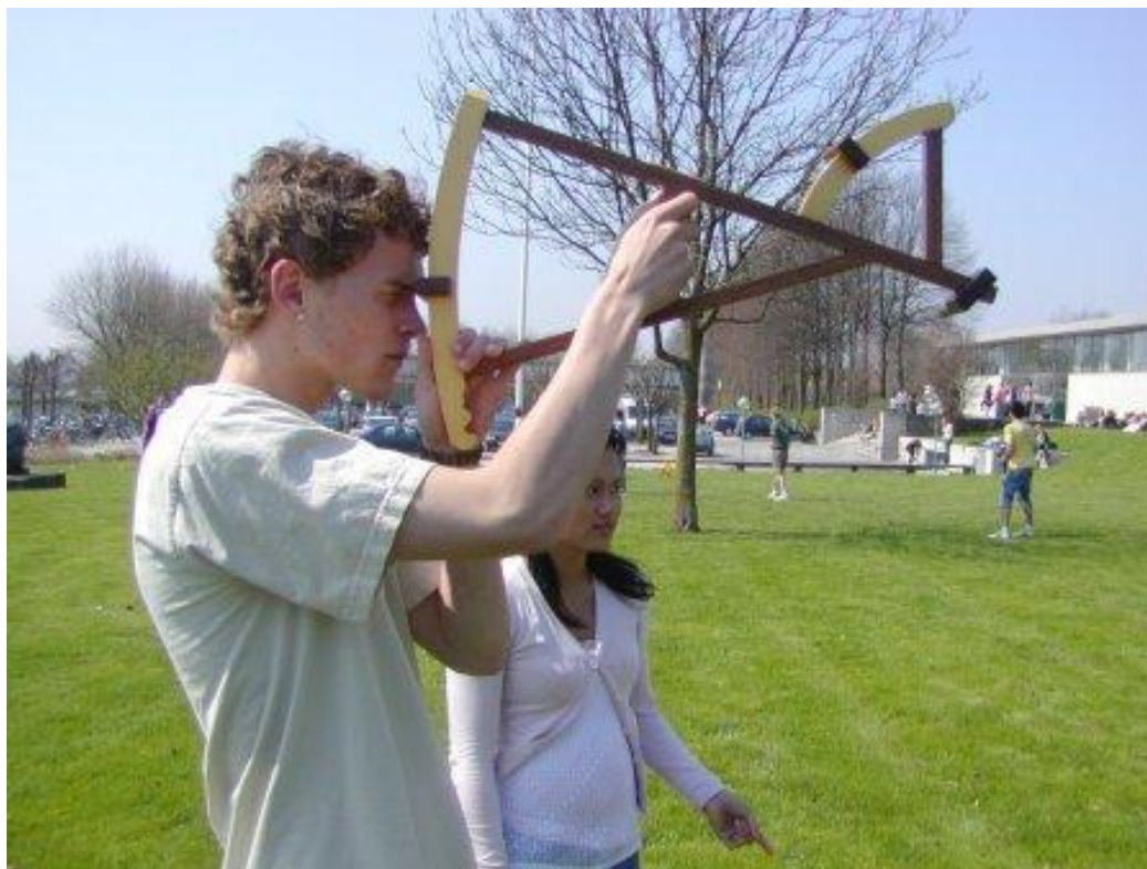
Figur 6 Måling af solhøjden – således holdes instrumentet
